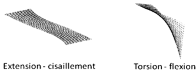
Figure 4-5 : Couplage extension-cisaillement et flexion-torsion d'une plaque rectangulaire laminée
