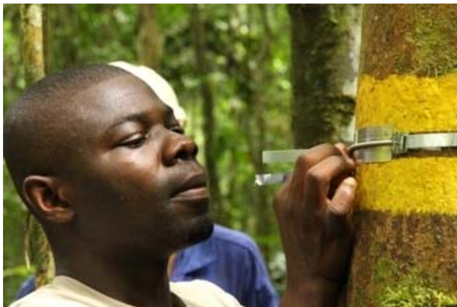
Le doctorant Achille Biwolé installe un dendromètre sur une tige d'azobé. © JL. Doucet
