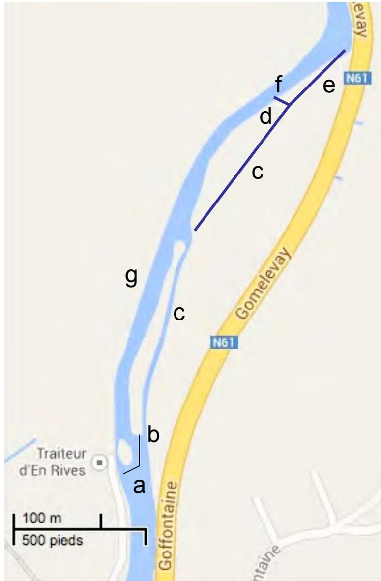
Figure 54: Plan semi-schématique du site de la CHE du moulin Fissenne sur la Vesdre à Goffontaine : a= barrage de prise d'eau (V12) ; b= entrée du canal d'amenée; c= long canal d'amenée ; d= turbines précédées d'une grille avec dégrilleur automatique; e= petit chenal latéral de retour à la rivière pour la vidange du bief l'évacuation des déchets de dégrillage ; f= canal de fuite; g= tronçon de 0,600 m de la Vesdre court-circuité.
