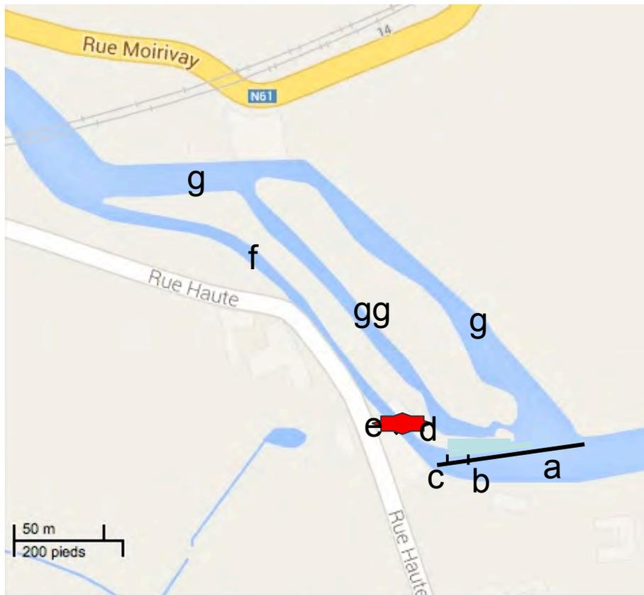
Figure 86. Vue aérienne (au-dessus) et représentation schématique correspondante (en-dessous) du site de la CHE De Bioley à Fraipont. a = barrage de prise d'eau.; b = vanne de vidange de la retenue + exutoire pour les déchets ; c= entrée du canal d'amenée ; c : grille et dégrilleur ; e=turbine ; f= canal de fuite, g= tronçon de rivière court-circuité constitué d'un bras droit (gd) et d'un bras gauche (gg).
