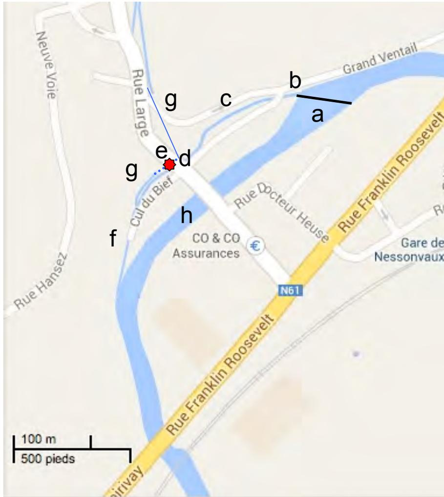
Figure 72. Représentation semi-schématique du site de la CHE du Moulin Pirard à Nessonvaux. a = barrage de prise d'eau. b= entrée du canal d'amenée avec vanne ; c : canal d'amenée ; d=espace souterrain abritant la grille et à sa gauche un chenal de décharge avec vanne; e=turbine ; f= canal de fuite ; g= Ruisseau de Vaux qui se jette dans le canal de fuite ; h= tronçon de Vesdre de 350 m court-circuité.
