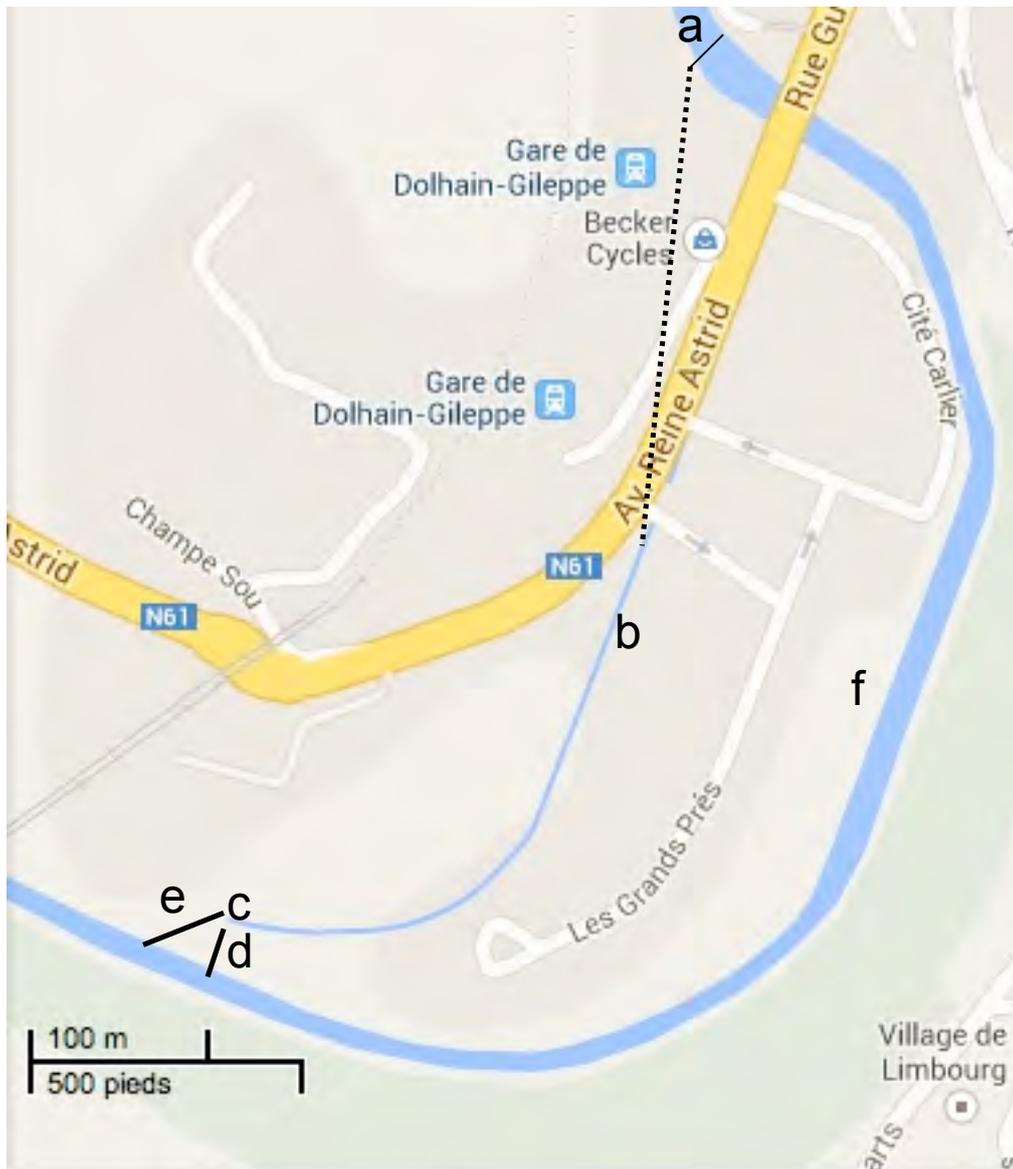
Figure 36 : Plan du site de la CHE Denis sur la Vesdre à Bilstain (Dolhain) : a= barrage prise d'eau (V20) ; b= canal d'amenée de 800 m en partie souterrain ; c= turbines précédées d'une grille avec dégrillleur ; d=t petit bras de trop-plein ; e= canal de fuite et de retour à la rivière ; f tronçon de la Vesdre court – circuité.
