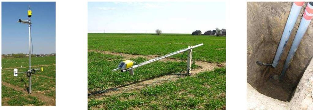
**Figure 6 : Mâts en aluminium sur lesquels reposent les nœuds et les capteurs (à gauche et au centre) - Implantation des capteurs sol, ici Decagon EC5, fixée à une profondeur de 20 et 50 cm (droite).**
