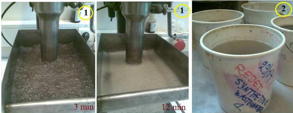
A: 500 g du minerai oxydé (3,15% Cu et 0,90% Co), ERS: Eau résiduaire synthétisée, ER: Eau résiduaire extraite des rejets
