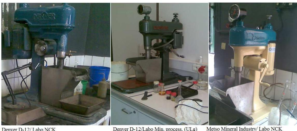
Figure 3. 31 - Machines de flottation utilisées pour les essais à l'échelle du laboratoire
