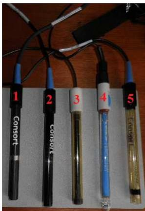
1. Electrode **SK10B general purpose** - **conductivity + ATC** pour la salinité
