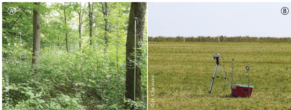
Figure 5 – Mesure de l'éclaircissement relatif à l'aide de capteurs photosensibles. L'éclaircissement relatif correspond au rapport entre la mesure de l'éclaircissement sous la canopée (a) et l'éclaircissement en plein découvert (b). Vu la difficulté de mesurer l'éclaircissement au-dessus de la canopée, il est mesuré à proximité en plein découvert.
