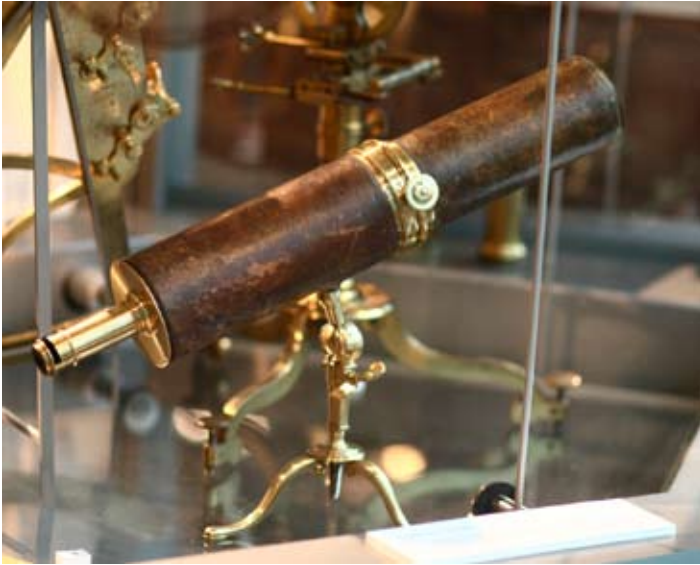
Télescope grégorien datant de 1735 environ et exposé au Harvard Science Center (wikipedia)
