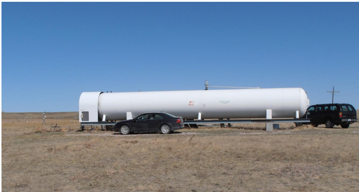
Figure 44: La bonbonne de CO 2 servant à alimenter les plots du site dont la concentration en ce gaz est augmentée.
