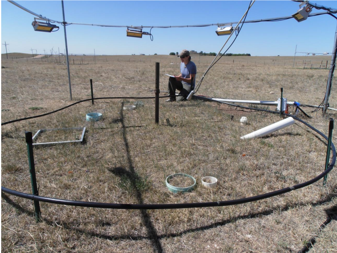
Figure 15: Un plot à la température et à la concentration en CO 2 augmentées. L'augmentation de la température est réalisée par les lampes IR disposées sur le cercle en métal à 1m50 du sol, et l'augmentation de la concentration en CO 2 de l'air est réalisée via la diffusion de CO 2 pur par le tube noir circulaire, placé à 15cm du sol.
