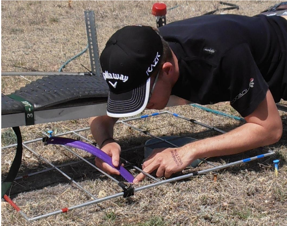
Figure 22: Démonstration du comptage et du mesurage des plants de B. tectorum au sein d'un plot. Les mesures s'effectuaient en équilibre sur une plateforme en bois ou en aluminium, et les zones à mesurer se démarquaient à l'aide d'un cadre en acier s'insérant dans des clous plantés dans le sol.
