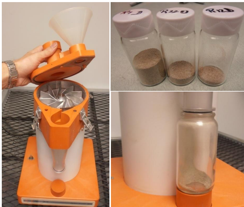
Figure 24: Le mixer (à gauche), les réceptacles contenant les plants sans les graines de B. tectorum mixés (à droite)
