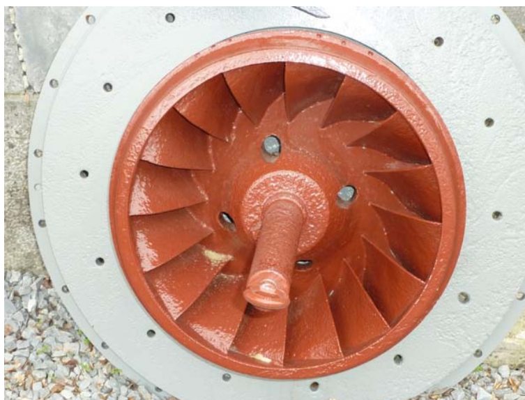
Figure 15. Exemple d'ancienne turbine Francis installée à la CHE de Moha sur la Méhaigne.
