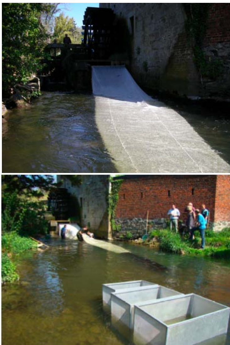
Figure 66. Filet mis en place en aval de la roue à aubes du moulin Heine à Fallais sur la Méhaigne pour récolter les poissons forcés à passer dans l'installation lors d'expériences menées en 2011 (source des photos : Benitez et al., 2011).
