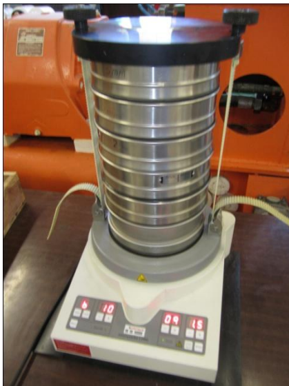
Figure 1 : Appareil de vibration mécanique et les 6 tamis de test
