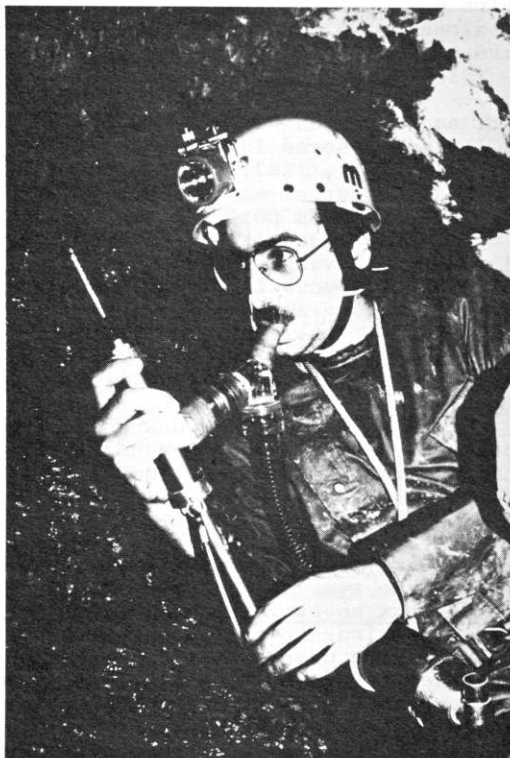
Figure 3.4 Mesure de la teneur de l'air en \text{CO}_2 en milieu confiné: le \text{CO}_2 respiratoire est absorbé sur de la chaux sodée contenue dans le réservoir visible à l'avant-plan. L'opérateur manipule la pompe à piston munie à son extrémité du tube indicateur (détecteur) (Photo C. Ek).
