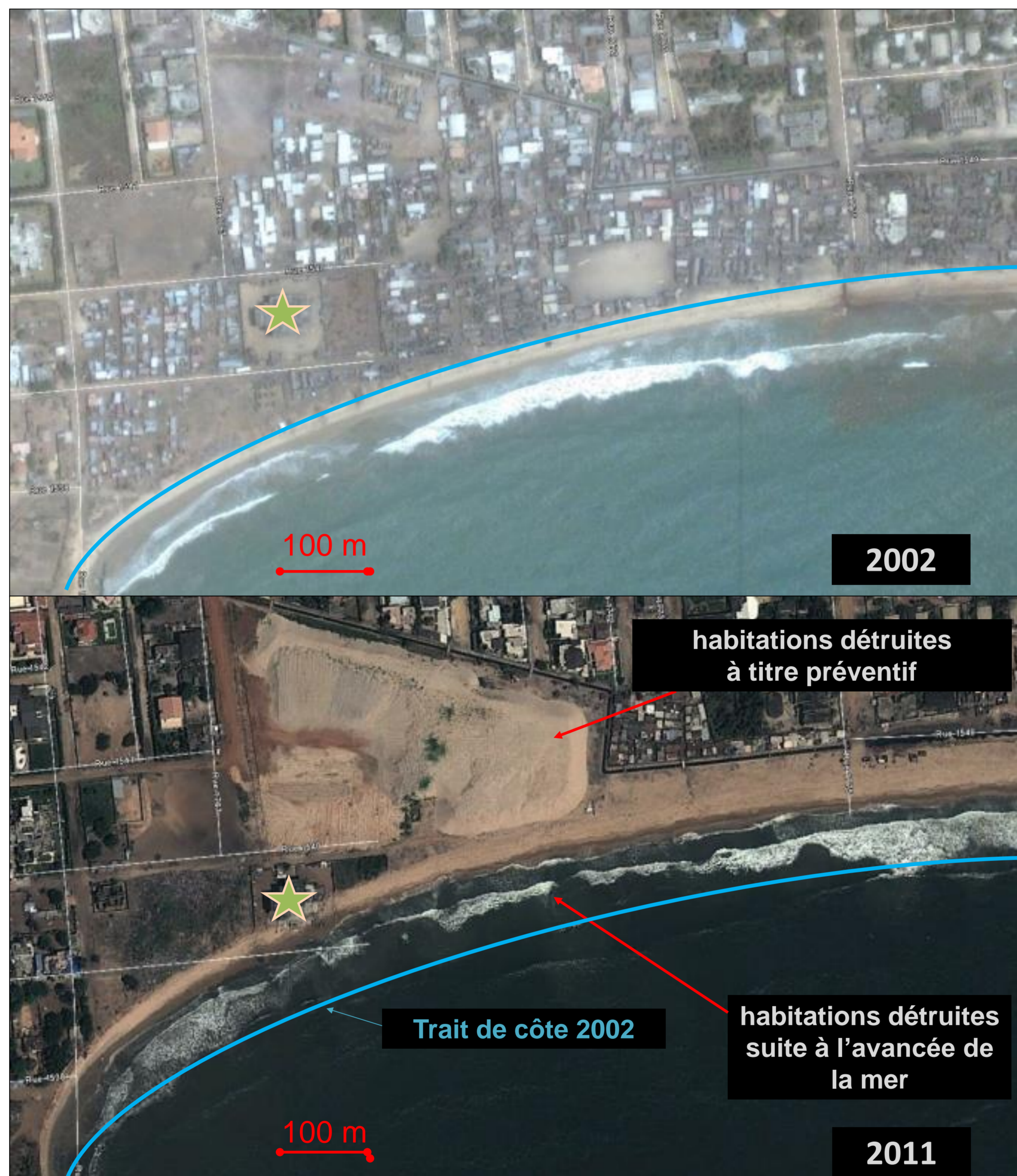
Figure 1: Images satellitaires disponibles sur Google Earth présentant les 800 premiers mètres à l'est de l'épi protégeant l'Hôtel Eldorado en 2002 et 2011. L'étoile positionne le bâtiment présenté à la Fig. 2.
