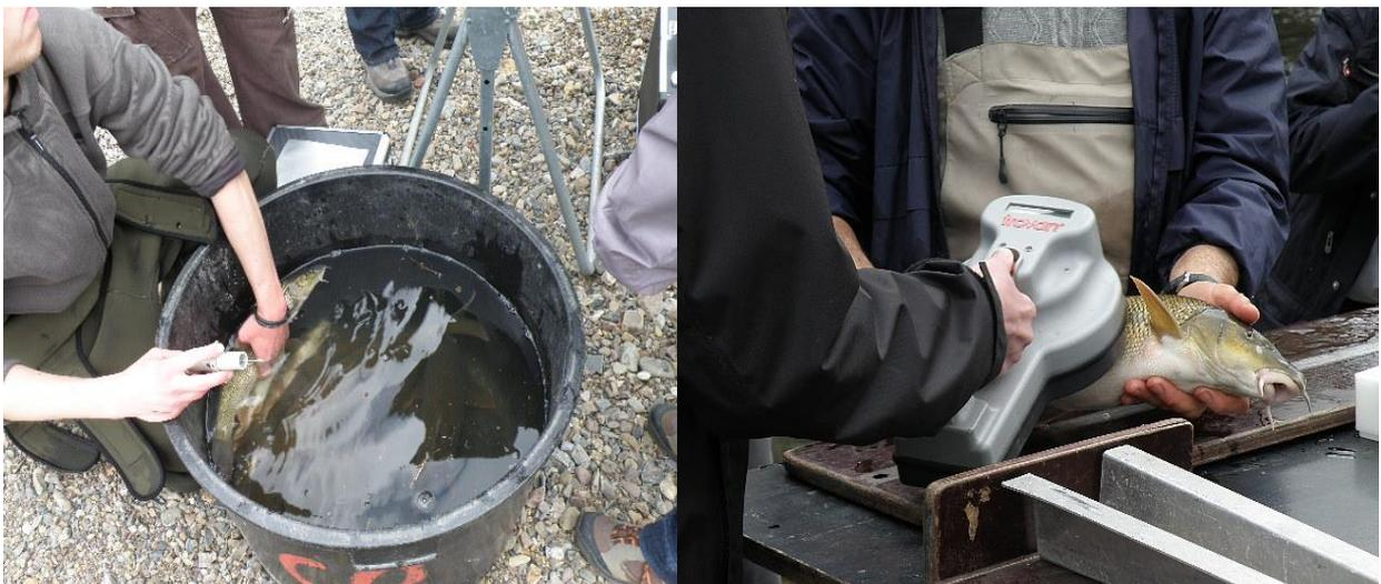
Figure 10 : Insertion d'un PIT-TAG (TROVAN®) et lecture de la marque avec le lecteur portable
