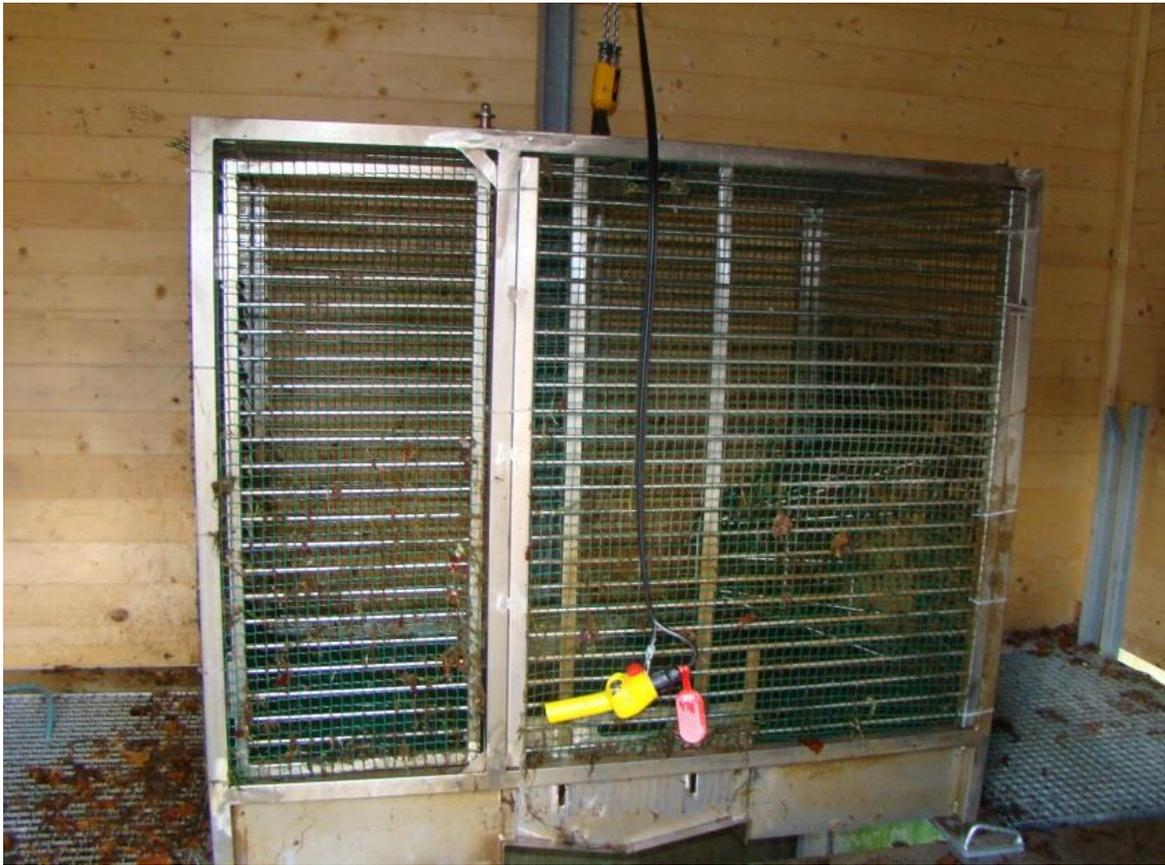
Figure 6 : Cage de capture placée au niveau du bassin le plus en amont de l'échelle à poissons du barrage de Lorcé (Amblève)
