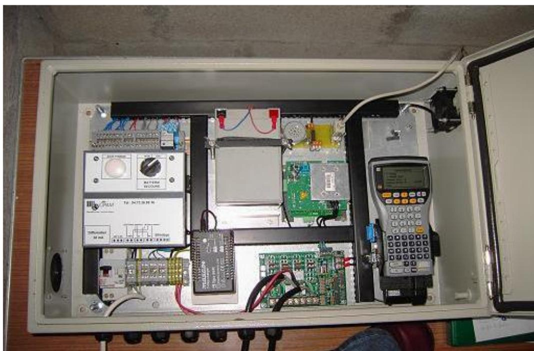
Figure 3 : Station de détection automatique CIPAM installé au niveau de l'exutoire de dévalaison du barrage de Lorcé
