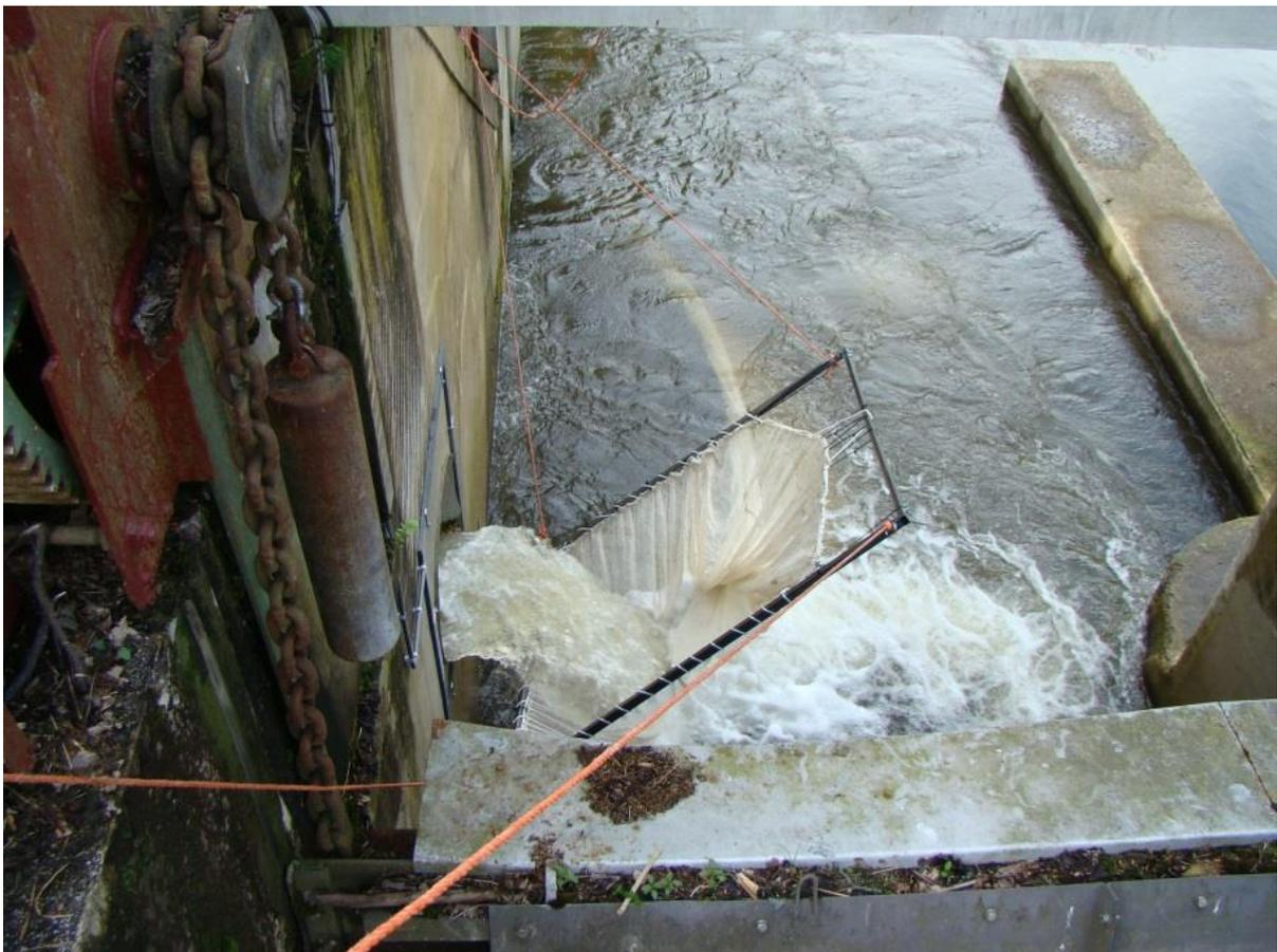
Figure 13 : Filet installé provisoirement à la sortie de l'exutoire du barrage de Lorcé pour récupérer les smolts passés dans l'exutoire
