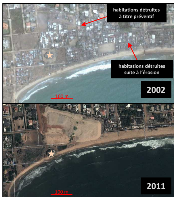
Figure 2: Images satellitaires disponibles sur Google Earth présentant les 800 premiers mètres à l'est de l'épi protégeant l'Hôtel Eldorado en 2002 et 2011.
