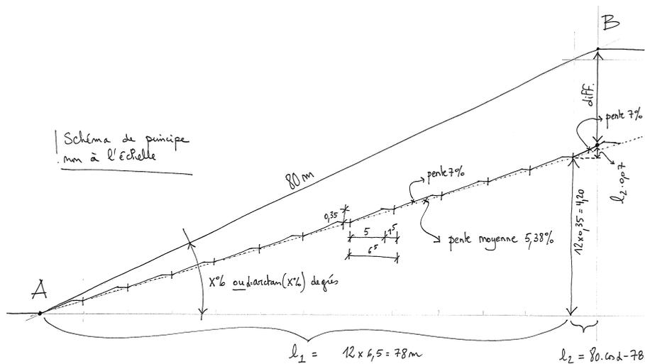
Une séquence complète (pente + palier) de la rampe numéro 2 fait 6,5 m horizontalement. Regardons pour commencer combien de séquences complètes de cette rampe il est possible de placer sur le terrain. Pour cela, nous devons connaître la longueur horizontale du terrain. Or, sur le schéma, dans le triangle  $ABC$ , la longueur Horizontale  $\overline{AC}$  du terrain est le côté adjacent à l'angle  $\alpha$ . De plus,  $\alpha = \arctan(6\%) = 3,43^\circ$ . Nous avons donc
