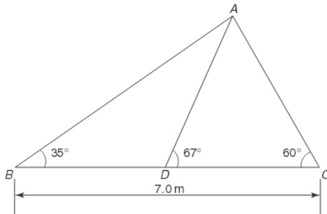
19.\* Déterminez les longueurs des éléments de la toiture de King Post représentée ci-dessous.
