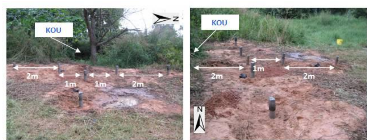
Figure 03 : Site de Nasso en rive droite du Kou (33 ouvrages disposés en croix)
