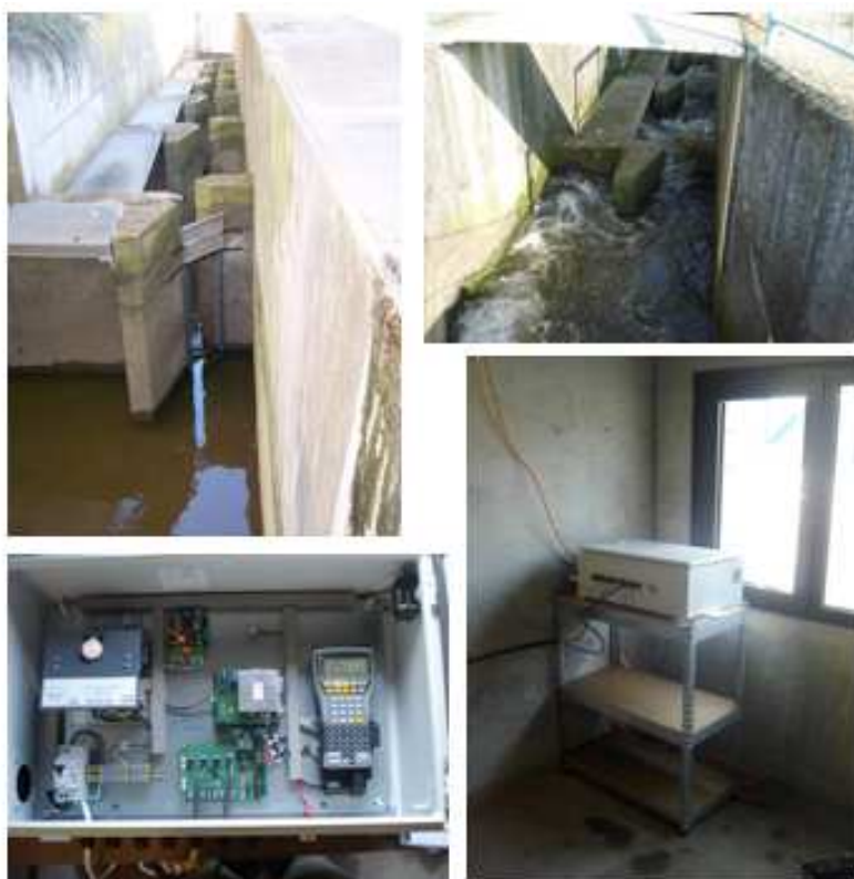
Figure 5. Détecteur CIPAM de poissons pucés installé en 2011 dans la passe à bassins du barrage d'Ivoz-Ramet sur la Meuse (km 97,1). Au-dessus : antenne de détection placée sur la fente du bassin supérieur à sec (à gauche) et sous eau (à droite). En-dessous : boîtier électronique (à gauche) abrité dans un local du barrage+centrale hydroélectrique (à droite).
