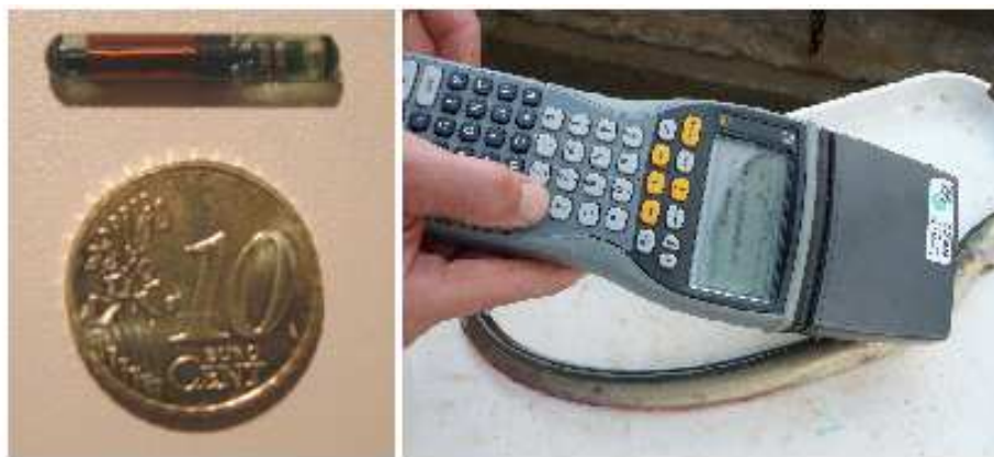
Figure 3. Transpondeur TIRIS (Texas Instrument) et lecteur de marque portable
