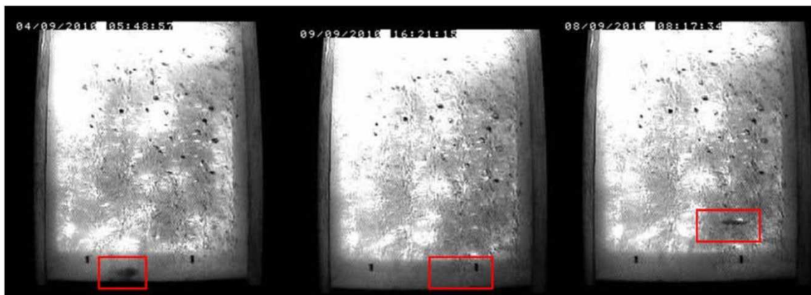
Figure 3 : Fixation importante d'organismes sur la vitre d'observation rendant difficile la détermination des poissons et réduisant le seuil de détection de la caméra
