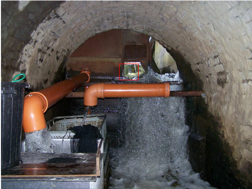
Figure 2 b. Le dispositif de piégeage à la dévalaison de Méry dans sa configuration en début 2011.
