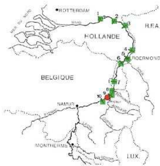
Figure 1. Position stratégique du barrage des Grosses Battes (point rouge) dans le bassin de la Meuse, à l'entrée (2,1 km de la Meuse) du domaine salmonicole du bassin de l'Ourthe. Les carrés verts indiquent la position des barrages équipés de nouveaux ouvrages de franchissement.
