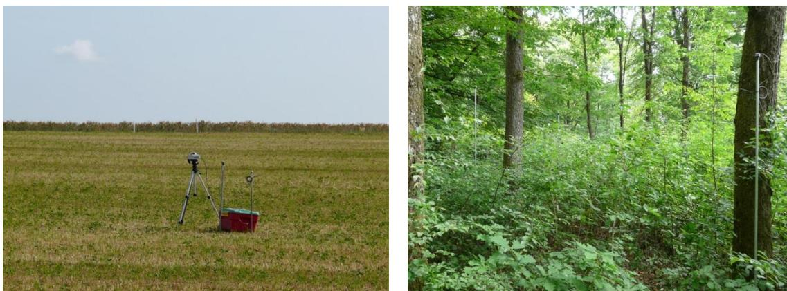
Figure 6 : A gauche, mesure de l'éclairage à l'aide d'un capteur photosensible en plein découvert (I0) ; à droite, mesure de l'éclairage transmis au-dessus de chaque plateau dans le sous-bois (I). Avec ces deux mesures il est possible de calculer l'éclairage relatif (I/I0).
