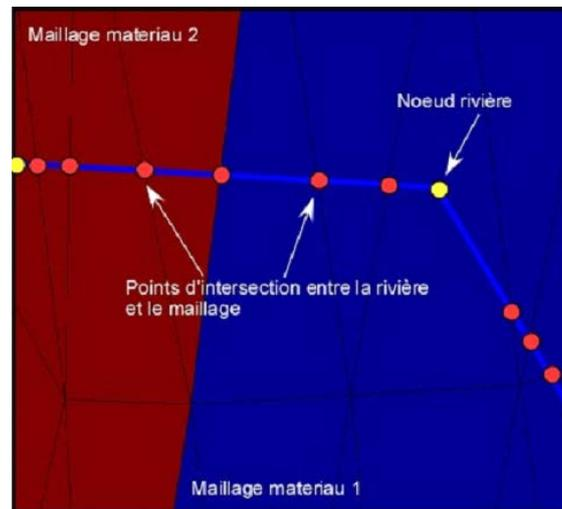
Figure 9 : Prise en compte du réseau hydrographique sur le maillage du modèle (les nœuds jaunes représentent les nœuds définissant le réseau rivière ; les nœuds rouges les intersections entre le maillage et le réseau rivière). Pour chaque tronçon de rivière défini entre deux nœuds rouges, une condition aux frontières de type Fourier est appliquée à la face du maillage traversée par ce tronçon
