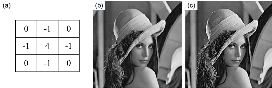
Fig. 33: Rehaussement de contraste à l'aide du Laplacien : (a) Laplacien utilisé, (b) image d'origine et (c) image d'origine traitée avec le masque Laplacien.
