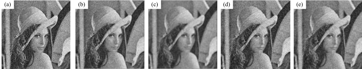
Fig. 28: Filtres linéaires : (a) image d'origine, (b) et (c) image d'origine traitée avec un filtre moyen [3 3] et un filtre moyen [5 5], (d) et (e) image d'origine traitée avec un filtre gaussien [3 3] ( \sigma=0.6 ) et un filtre gaussien [5 5] ( \sigma=1 ).
