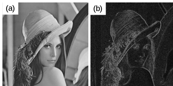
Fig. 164: Détection des contours à l'aide d'un Laplacien : (a) image d'origine et (b) résultat de la convolution de l'image d'origine avec un filtre Laplacien [3 3].
