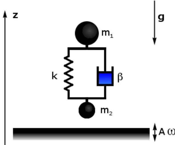
**Figure 2.** Représentation du modèle du ressort rebondissant. Deux masses  $m_1$  et  $m_2$  sont liées entre elles par un ressort de raideur  $k$  et par un amortisseur de viscosité  $\beta$ . L'objet est contraint de rebondir sur un plan rigide oscillant à amplitude  $A$  et pulsation  $\omega$ .
