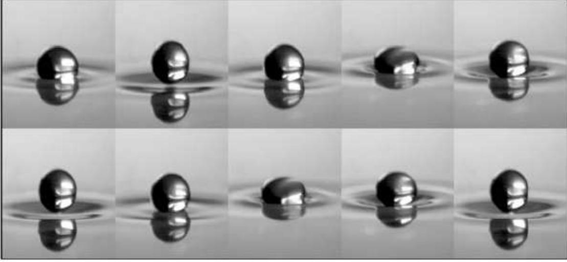
**Figure 1.** Rebond d'une goutte sur une surface de fluide vibrée verticalement. Notons le décollage périodique de la goutte ainsi que sa déformation importante. D'après [12].
