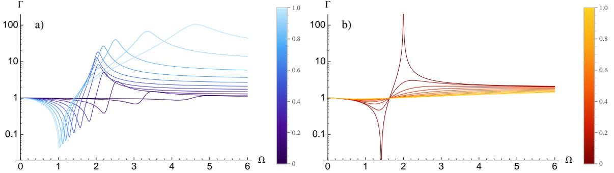
**Figure 3.** Seuil de rebond du ressort en fonction de la fréquence réduite (en échelle logarithmique). En (a), la valeur du coefficient de dissipation a été fixée à  $\xi = 0.02$  et le rapport de masse  $\mu$  a varié de 0 à 1. En (b), nous avons fixé le rapport de masse  $\mu = 0.5$  tandis que le coefficient de dissipation était libre de varier de 0 à 1. Nous pouvons constater que le rapport de masse et la dissipation ont tout deux un effet sur la position et l'amplitude des extrema.
