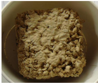
Granulat 4/8 et mélange de sable + argile en sac → enduit industriel
