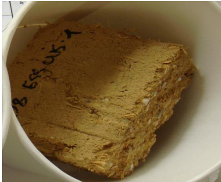
Sable, paille et argile wallonne → enduit manufacturé
