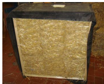
Figure 7. Cadre de paille testé sur la plaque chaude (1m x 1m)
