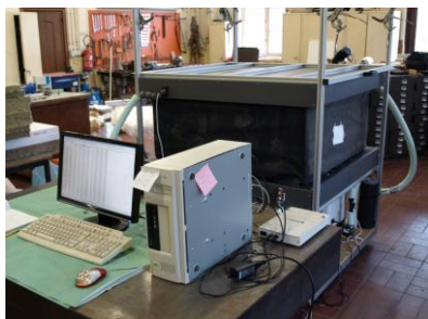
Figure 6. Plaque chaude gardée à une éprouvette
