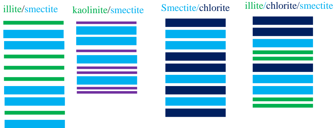
Figure I.9: Différentes possibilités d'interstratification au sein des minéraux argileux avec deux ou trois composants
