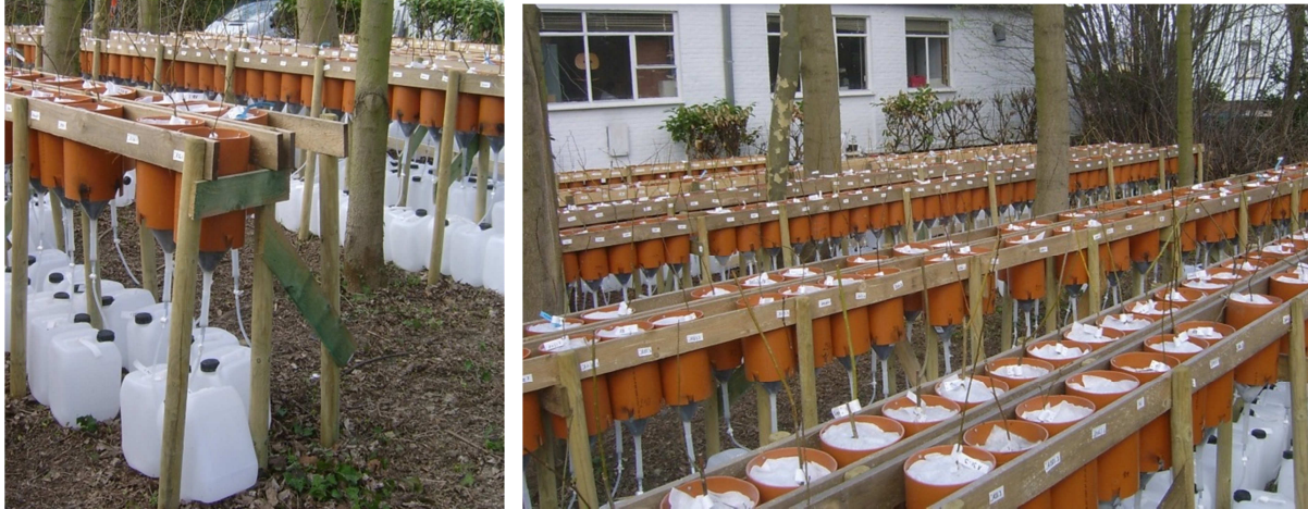
Figure VIII : Vue d'ensemble de l'expérience en conteneurs. En dessous de ceux-ci, ont été installés des bidons afin de récolter les lixiviats (Photos : A. Evlard).
