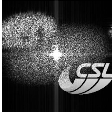
Figure B.19 : Simulation de la reconstruction d'une image par holographie digitale.
