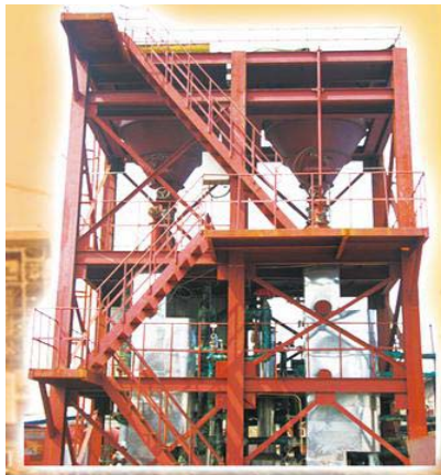
图6 褐煤干燥中试试验系统
