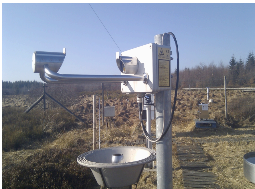
Figure 1: Disdromètre à laser (Thies). Photographie prise au parc météo (ULG) au Mont Rigi, Belgique.
