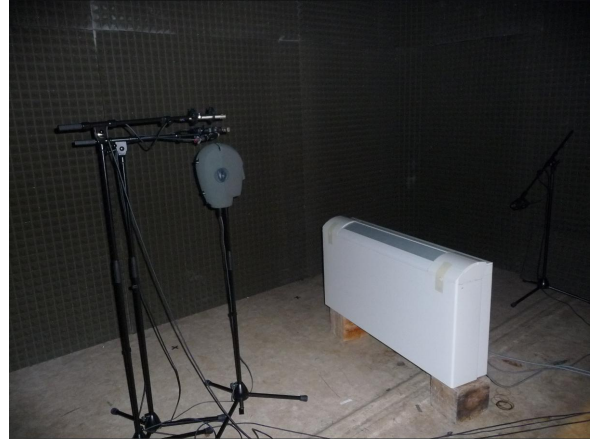
FIGURE 4.4 – Photo de l'installation pour l'enregistrement du son du système CRS3 (voir tableau D.1 en annexe).
