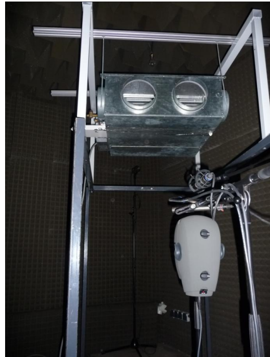
FIGURE 4.8 – Photo de l'installation pour l'enregistrement du son du système GNB5 (voir tableau D.1 en annexe).
