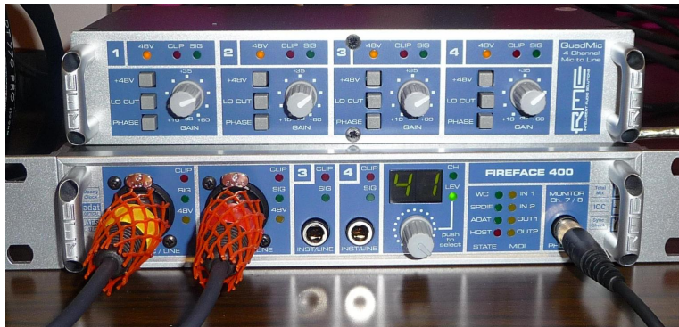
FIGURE 4.2 – Photo de l’interface audio RME Fireface 400 (en bas) et du préamplificateur RME Quadmic (en haut)
