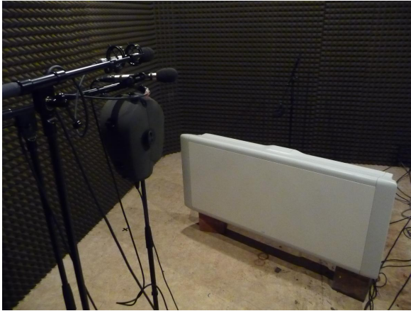
FIGURE 4.3 – Photo de l'installation pour l'enregistrement du son du système CRS1 (voir tableau D.1 en annexe).
