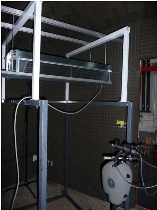
FIGURE 4.7 – Photo de l'installation pour l'enregistrement du son du système GNB4 (voir tableau D.1 en annexe).
