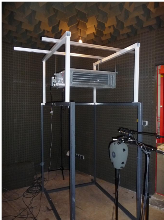
FIGURE 4.5 – Photo de l'installation pour l'enregistrement du son du système GNB1 (voir tableau D.1 en annexe).
