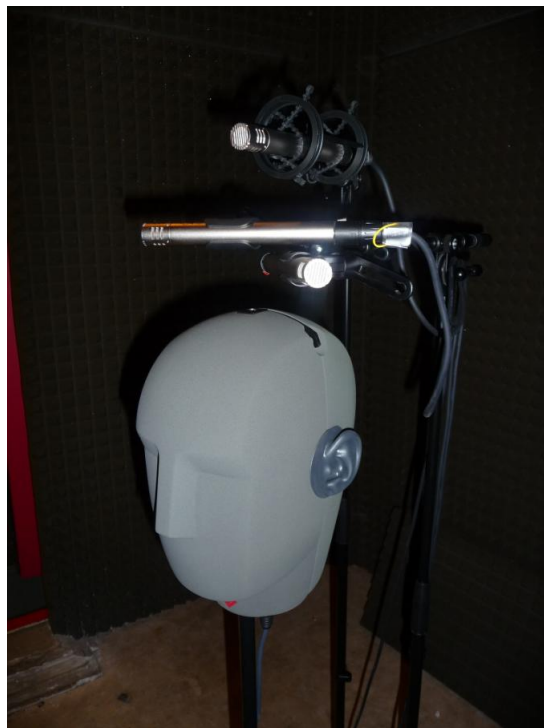
FIGURE 4.1 – Configuration des microphones pour l'enregistrement
