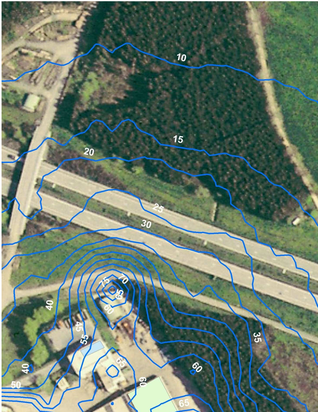
Figure 19 : Iso-courbes correspondant au percentile 98 pour différentes concentrations d'odeur (définissant les valeurs d'exposition de riverains qui vivraient à ces endroits), sur un "zoom" aux alentours du site.
