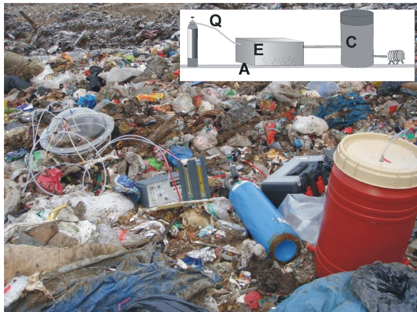
Figure 2 : Prélèvement par chambre de flux sur une surface de déchets
