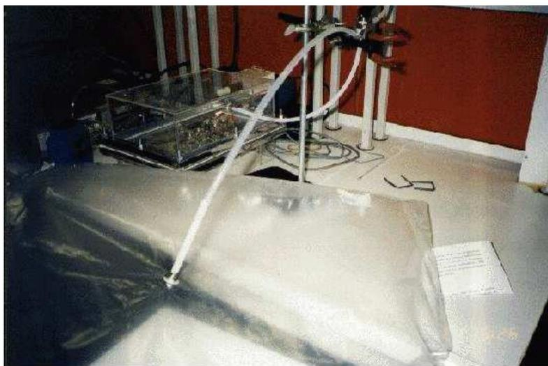
Photo 4.2. Aperçu du dispositif d'aspiration de l'échantillon l'échantillon vers la chambre à l'aide d'une pompe en aval (en haut à gauche de la photo).
