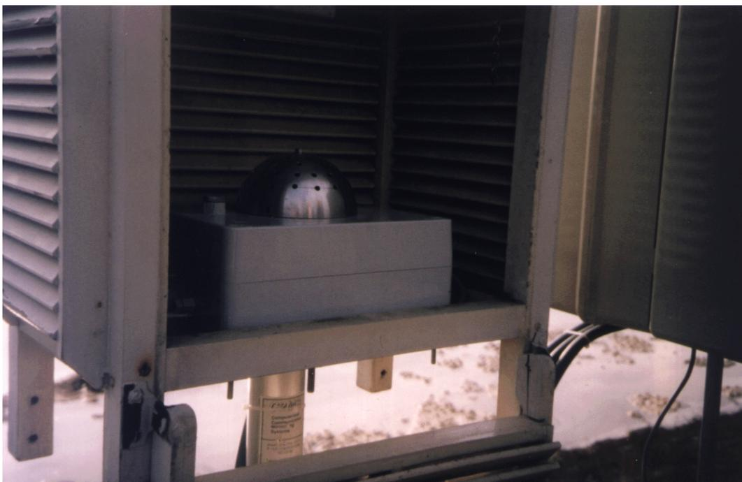
Photo 7.2. Vue de l'intérieur de l'abri où sont placés les 4 capteurs TGS sur le terrain à Genappe.
