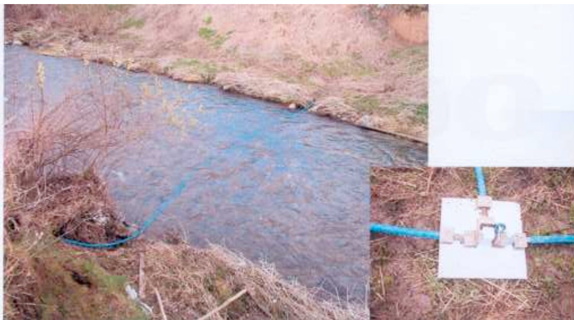
Photo 5/1. Cable-antenne de détection des poissons marqués installé par l'équipe de l'INBO en travers de la Berwinne à Moelingen en début avril 2007 ( Photo H. Verbiest, INBO).
