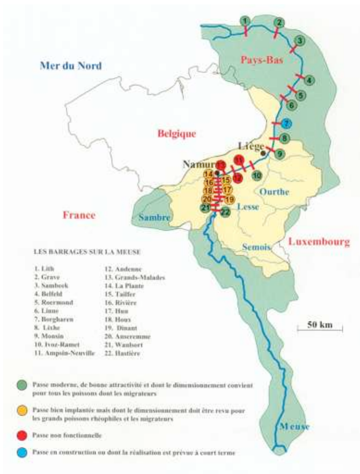
Figure 13/4. Etat d'avancement en 2007 de l'équipement en échelles à poissons modernes des barrages sur l'axe Meuse entre la mer du Nord et la France (MRW - Malbrouck et al., 2007).
