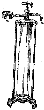
Fig. 97. — Récipient en verre épais, dans lequel on peut soumettre un petit animal à l'action de l'oxygène comprimé à plusieurs atmosphères de pression; t , tube amenant l'oxygène de la pompe, r , robinet, m , manomètre.
