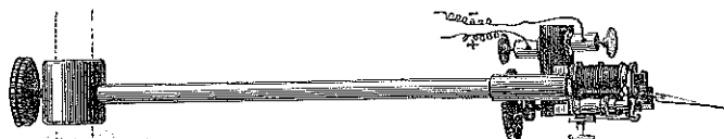
Fig. 30. — Signal électro-magnétique de Marcel Deprez (demi-longueur).
