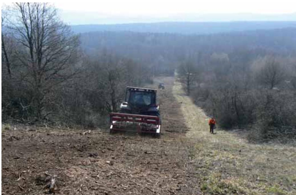
Une fois la coupe réalisée, le passage d'un gyrobroyeur à 5 cm dans le sol permet de calmer la repousse des rejets et d'éliminer les souches. Photo : Olivier Kints
