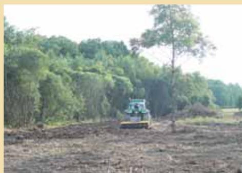
Tracteur et gyrobroyeur à cylindre, avec marteaux tournant perpendiculairement au sol. A n'utiliser que pour les restaurations lourdes, car trop destructeurs en entretien pour la petite faune.
