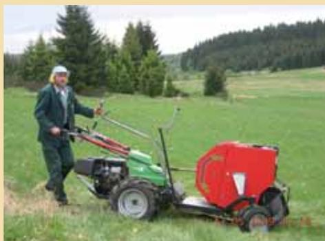
Motofaucheuse utilisée dans les prairies de fauche en pente ou trop étroites pour les machines agricoles classiques. Elle peut également être équipée d'une balloteuse pour ramasser le produit de fauche.
