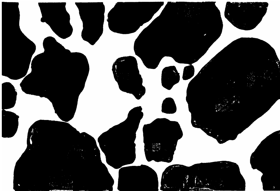
Figure 42 : repérage des matériaux pierreux sur la photo ci-dessus.
